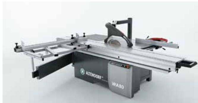
участку длиной до макс. 3500 мм. Если размер раскроя на длину превышает 1700 мм, устойчивая, телескопически выдвигающаяся опора поддерживает внешний откидной упор.
