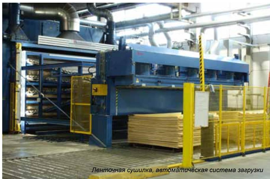
Ленточная сушилка, автоматическая система загрузки
