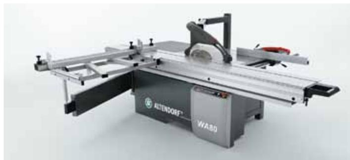
быстро и точно произвести установку на заданный размер. После ввода значений упор со скоростью 250 мм/сек перемещается в нужную позицию, причем делает это с точностью до 1/10 мм. При повороте пильного диска или переводе упорной планки в горизонтальное или вертикальное положение автоматически выполняется подналадка.
