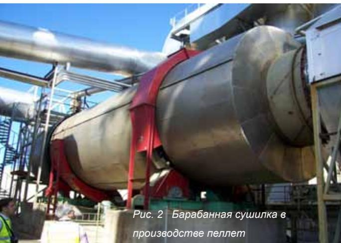
Рис. 2 Барабанная сушилка в производстве пеллет
