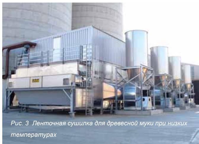
Рис. 3 Ленточная сушилка для древесной муки при низких температурах
