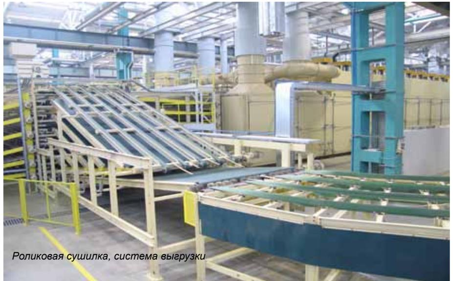
Роликовая сушилка, система выгрузки
