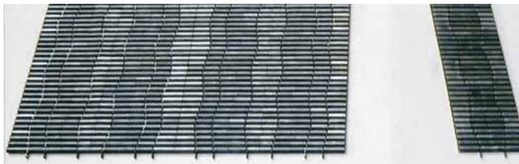
Полотно образовано множеством роликовых стержней диаметром 12,5 мм, соединенных накладками. Ширина стержней полотна снаружи составляет 550 мм, что позволяет увеличить ширину продукта более, чем на 600 мм. Разная длина стержней образует в полотне характерные «волны» из накладок, что обеспечивает хорошее распределение давления по всей плоскости прессования, без отпечатков в виде «рельсов».
