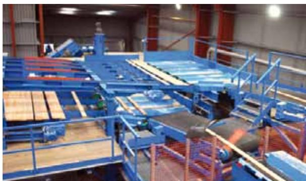
Два этажа боковин: из обрезного станка приходит материал со скоростью 400 м/мин, тормозится и транспортируется поперек. Фото: Эбнер
